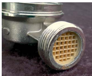
Abb. 11: Siebe im Einlauf von Wasserzählern verhindern das Eindringen grober Schmutzpartikel. Kalkablagerungen und Rostschlamm können sie aber auch nicht verhindern.
