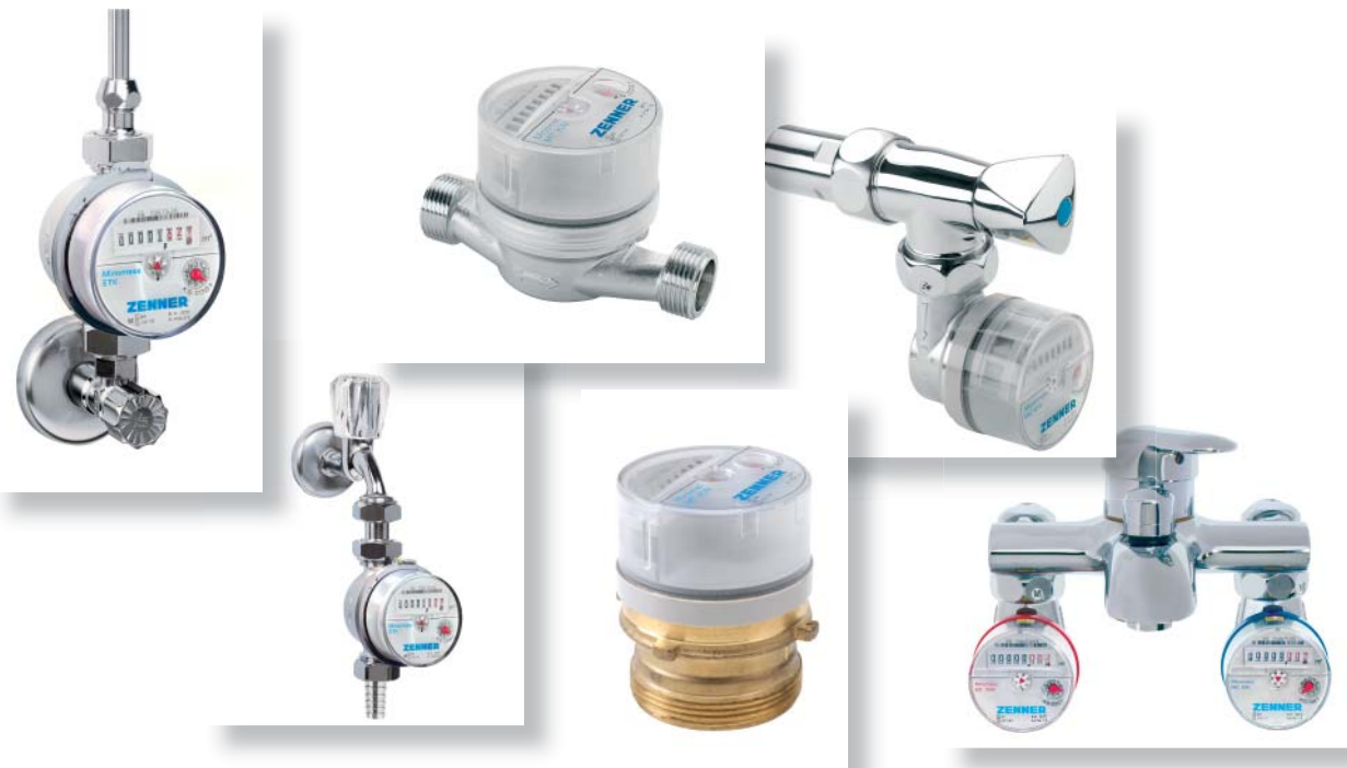
Abb. 8: Verschiedene Bauformen von Wohnungswasserzählern mit Badewannenzähler, Zapfhahnzähler, Waschtischzähler, Ventilzähler, Unterputtzähler, Aufputzzähler. Es handelt sich immer um Einstrahlzähler als Trockenläufer.
